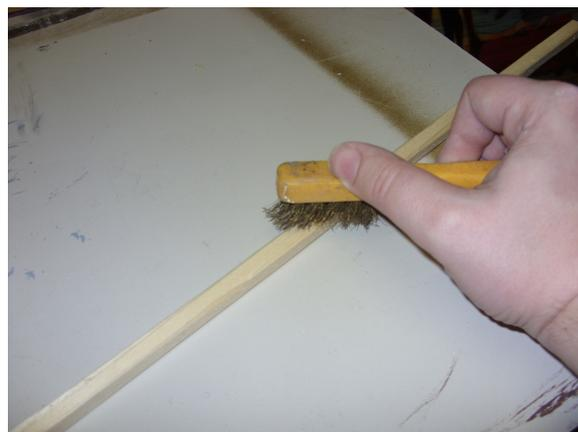
Ein **wichtiger Punkt** ist außerdem, dass Sie die Holzleisten, nachdem Brechen der Kanten, mit einer Drahtbürste aufrauen. Somit kann anschließend die Beize auch besser eindringen.
